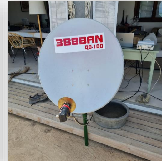
85cm Spiegel mit ca. 15W Ausgangsleistung
